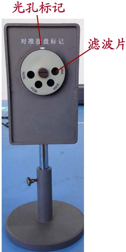
光电管暗盒上有一光孔(其位置由白色倒三角“▽”所标记), 并且安装着带有4种滤波片的旋转盘。汞灯经4种滤波片可生成4种波长(365, 405, 436, 546nm)单色光, 它们分别通过暗盒的光孔照射光电管阴极K产生光电效应。
